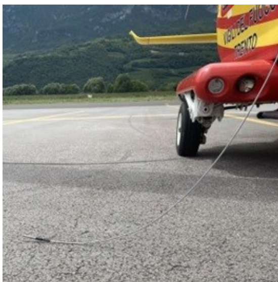
Cavo di messa a terra
